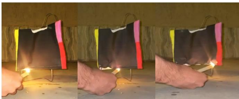
Figura 4: Experimento de combustão gabardine 70ml
