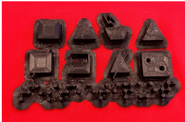
Figura 2 – Teste realizado na impressora 3D com filamento ABS, que não foi aprovado.
