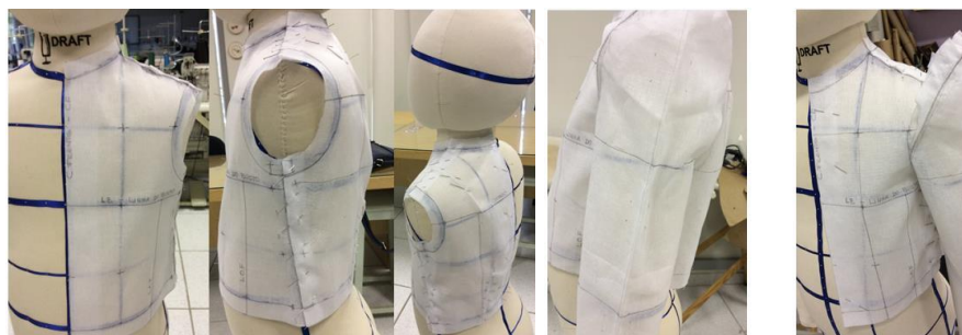
Figura 6: Peça montada com alfinetes e prova no manequim
