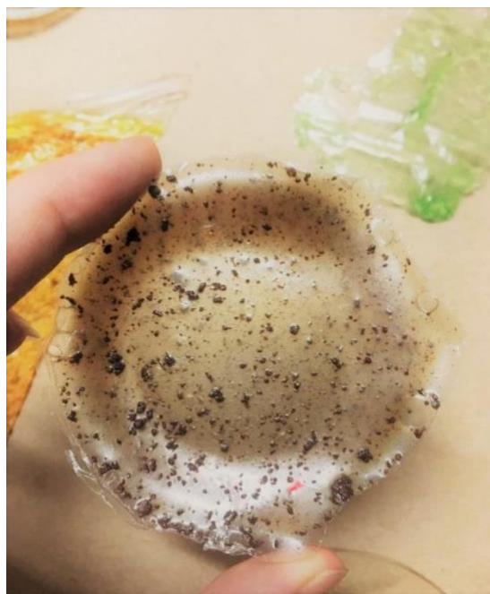
Figura 3: Bioplástico de amido de mandioca
