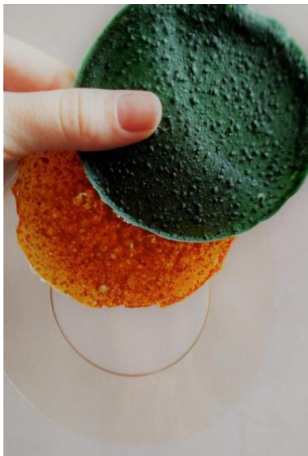
Figura 2: Bioplástico de gelatina, physillium e chia
