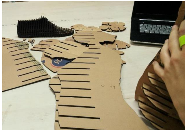
Figura 7: Construção de manequim com escâner 3D
