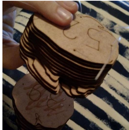
Figura 14: Fatiamento e corte à laser do modelo 3D
